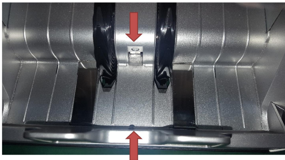
<Czujniki kieszeni odbiorczej>
